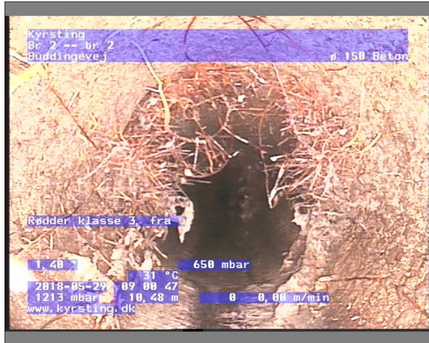
Foto: Br 2-br 20900569-29-05-18_A.JPG, Medie #:: De Engelske _0, 00:01:41 10,48m, Rødder klasse 3, fra uref 7 til uref 3, Fine rødder
