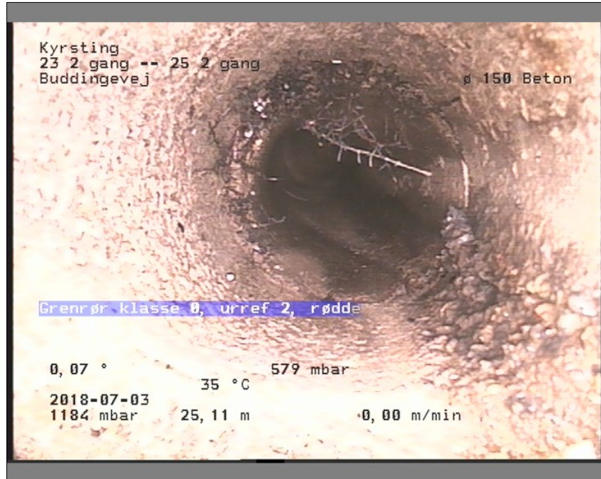
Foto: 23 2 gang-25 2 gang09291714-29-05-18_A.JPG, Medie #: De Engelske _0, 00:05:28 25,11m, Grenrør klasse 0, urref 2 / rødder i gr
