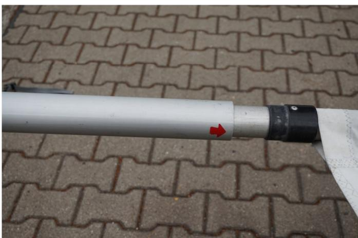
**Abb. 6** – Mast Oberteil und Unterteil zusammenstecken
