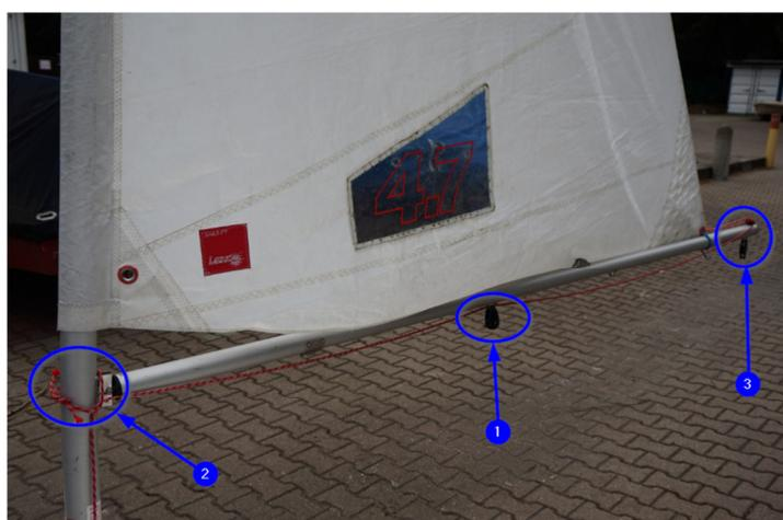
Abb. 20 – Unterliekstrecker entlang des Baums zum Mast führen
