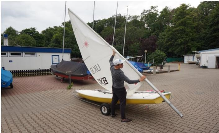
**Abb. 13** – Greifen des Mastes zum Einstecken
