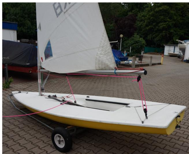
Abb. 32 –Eingefädelte Großschot - Finales Bild
