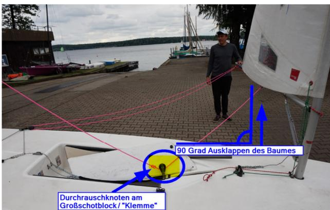
**Abb. 34** – Durchrauschknoten am Großschotblock
