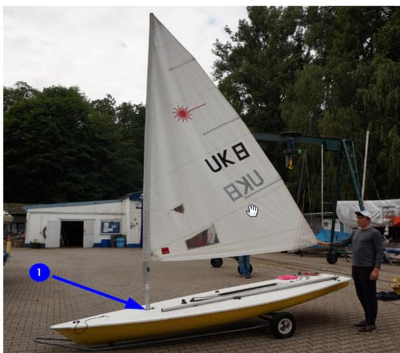
**Abb. 15** – Eingesteckter Mast mit Großsegel
