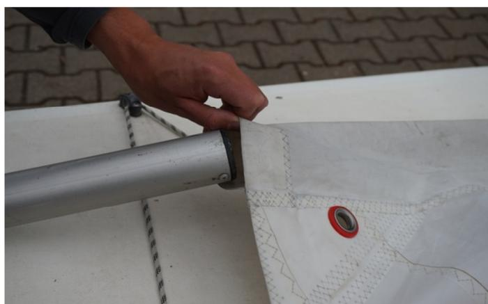
Abb. 3. – Einführen Mast Oberteil in Großsegel (Niete zeigt nach unten)
