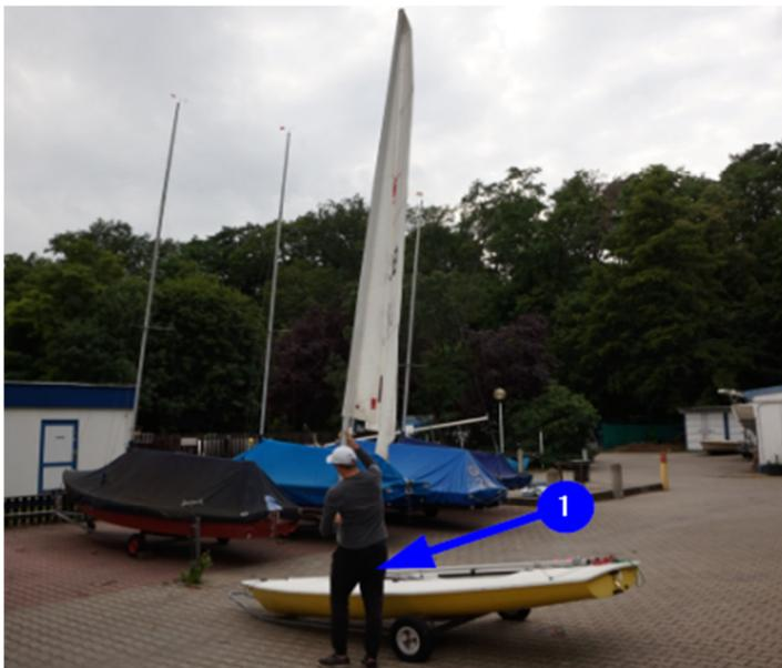
**Abb. 14** – Einstecken des ;Mastes mit Großsegel
