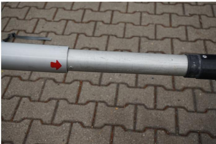
**Abb. 5** – Mast Oberteil und Unterteil zusammenstecken
