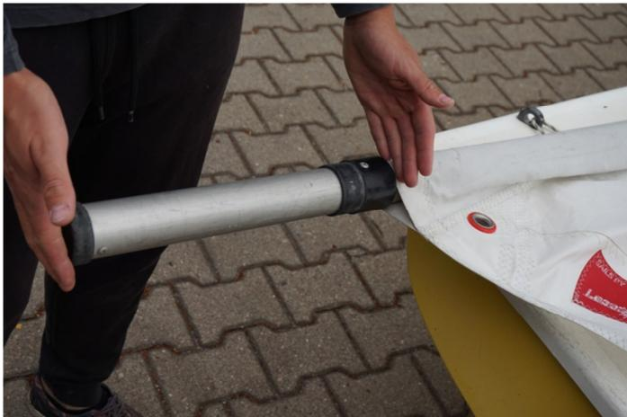
**Abb. 4** – Mast Oberteil eingeführt bis auf „Stecksystem“
