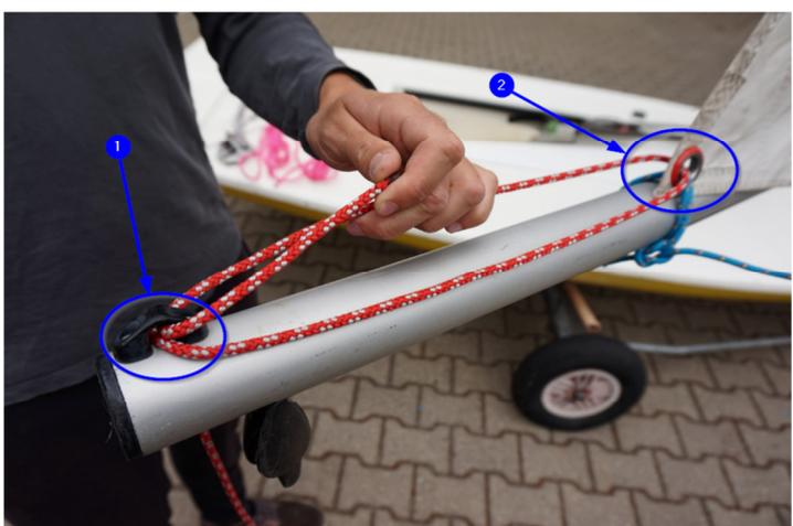
Abb. 18 – Unterliekstrecker durch Schothorn und Baum führen
