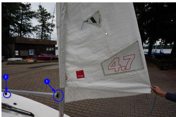
Abb. 16 – Baum über Lümmelbeschlag anschlagen
