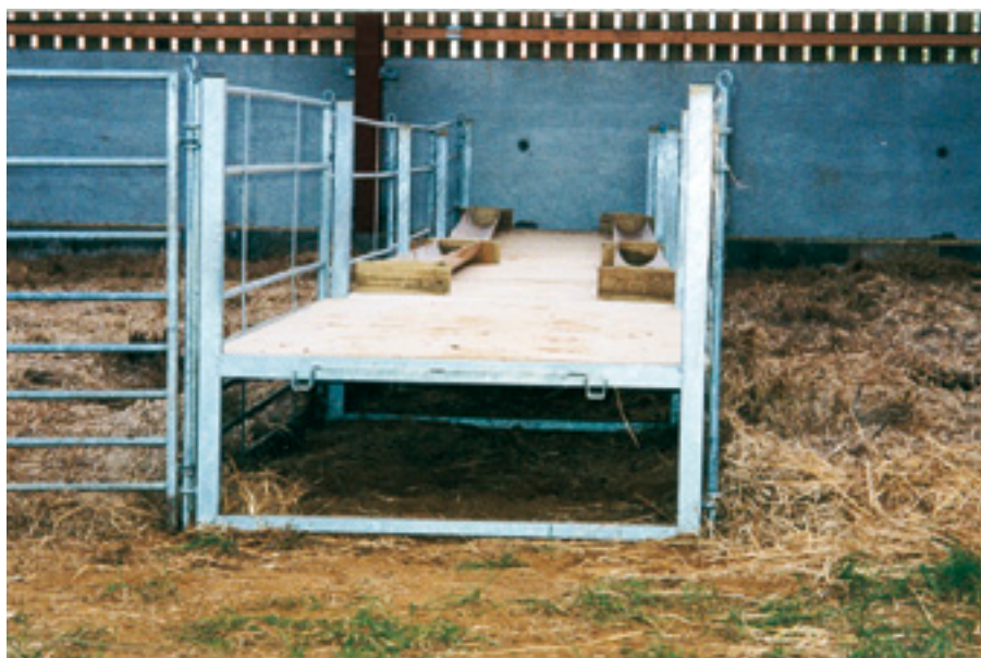
Bemærk de tværgående foderborde samt udformningen af væggen, der giver en fortrinlig naturlig ventilation. Den nederste halvdel af væggen er opført af betonelementer. Stalden tilhører Mette Marie Thomsen og Svend-Erik Svenningsen, Vinderup. Foderbordet er hævet i forhold til lejet. Bemærk anvendelsen af grinder.
