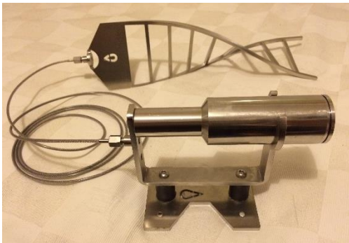
Foto af Power Pack med monteringsbøjle monteret med stålwire til peritrakt (DNA-Helix).
