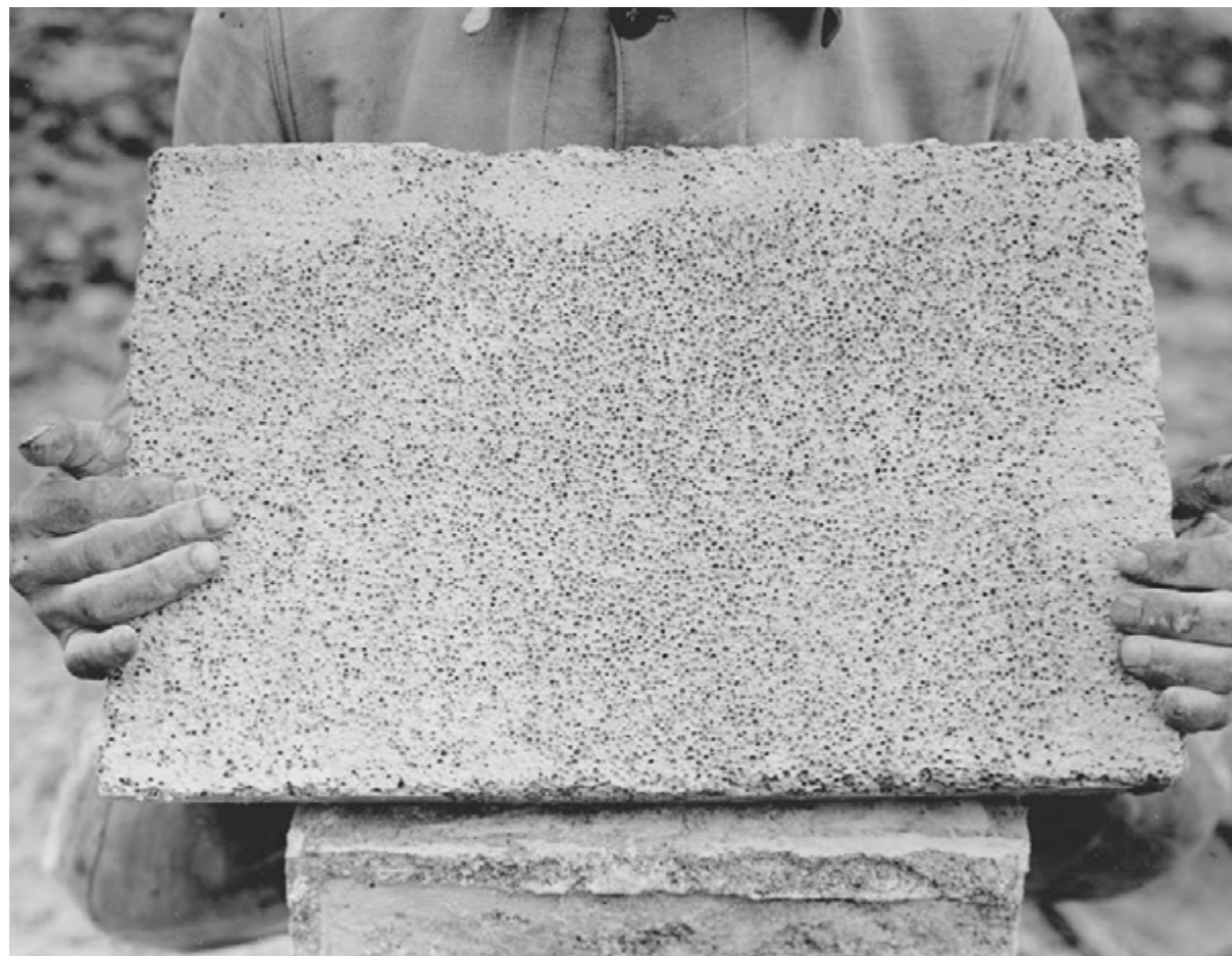
Gasbetonblokken die bij ENCI werden gemaakt voor het isoleren van het verdeelstation (Fotoarchief ENCI)
