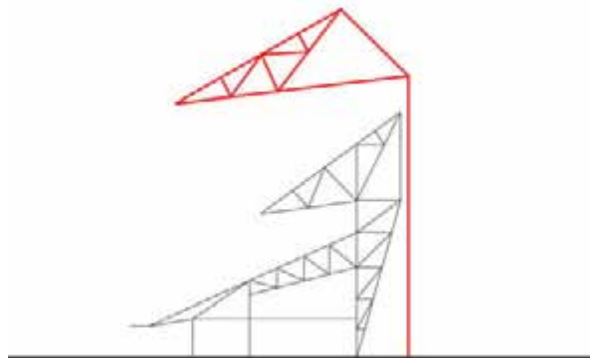
Vervolgens kon de overkapping worden geplaatst
