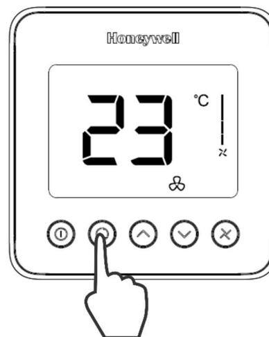
ahorro de energía esté habilitado. El rango de temperatura de calentamiento es de 10°C a 21°C y el valor predeterminado setback es de 18°C. El rango de enfriamiento es de 22°C a 32°C y el valor predeterminado setback es 26°C.
