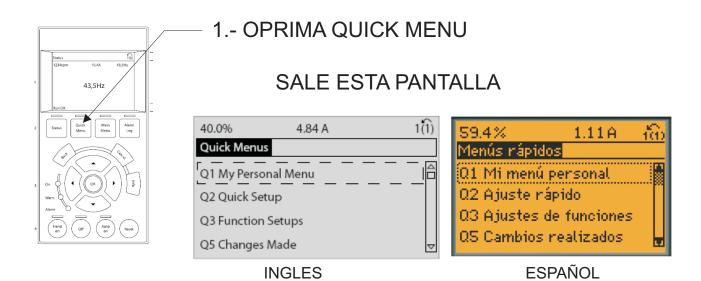
Seleccionar la opcion Q2 Quick Setup (Ajuste rápido) Entrar en cada uno de los parametros y especificar conforme a datos de placa del motor.
