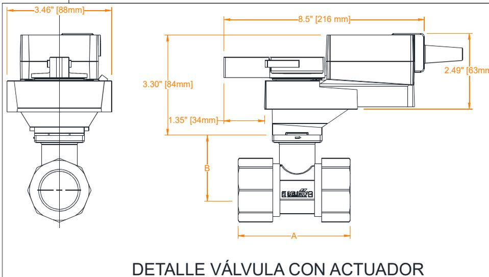
DETALLE VÁLVULA CON ACTUADOR
