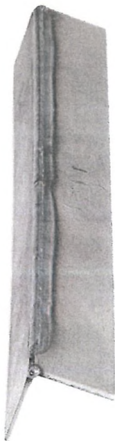
Fig. 9 Udvendig hjørnesøm svejsestilling PG
