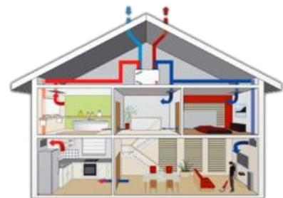
Aanleg balansventilatiesysteem in een woning
