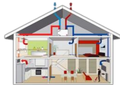
Aanleg balansventilatiesysteem in een woning
