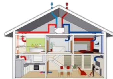
Aanleg balansventilatiesysteem in een woning
