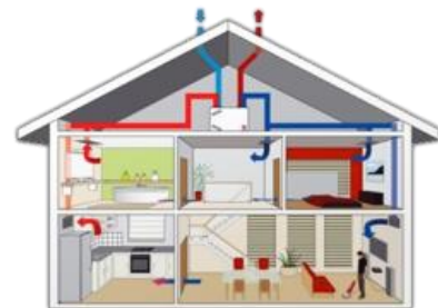
Aanleg balansventilatiesysteem in een woning
