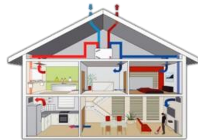
Aanleg balansventilatiesysteem in een woning
