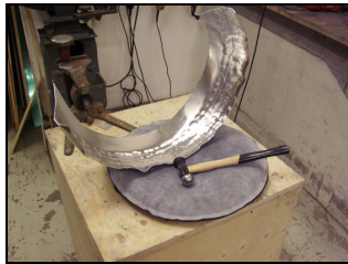
Grovformning med hjälp av sträckning med kulhammare mot sandsäck.
