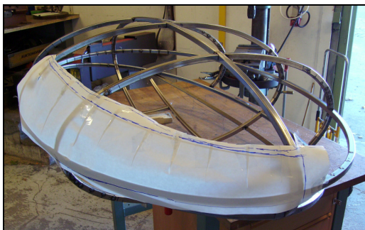
Beräkning av utbredningen med hjälp av en pappers mall.
