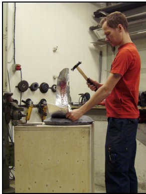
Grovformning med hjälp av sträckning med kulhammare mot sandsäck.
