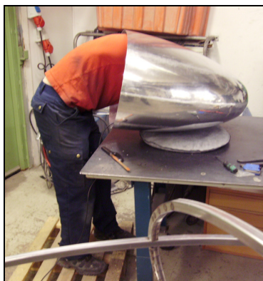
1. Slipning av insidas svetsfog
