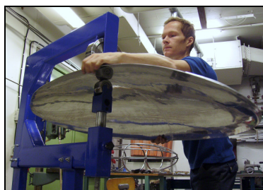
5. Utjämning av svetsfogen på locket
