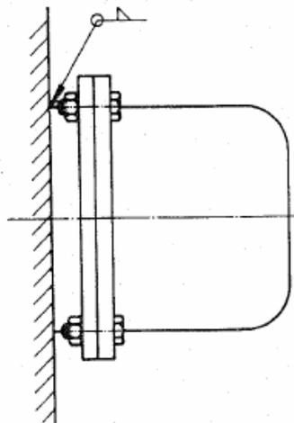
Die Zwischenstücke sind für die Befestigung von Puffern nach NO 16940 bzw. NO 16952 geeignet.
