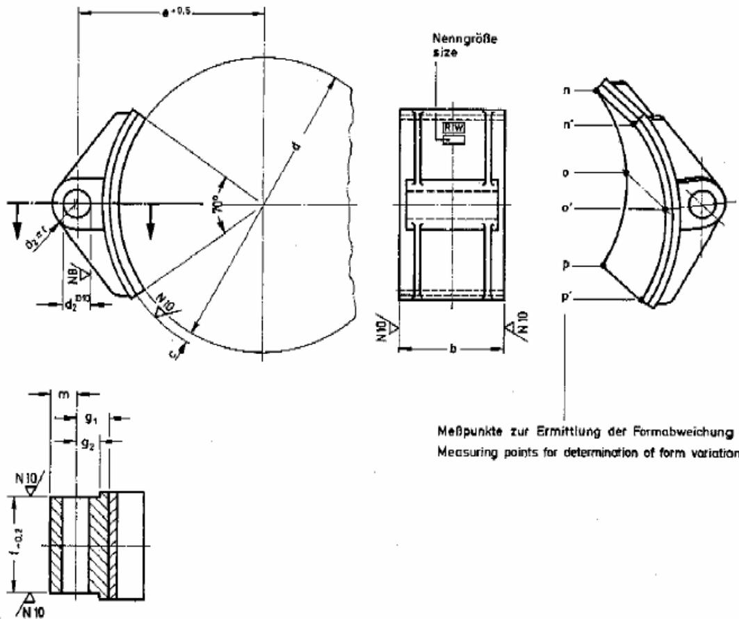
Bezeichnung einer Bremsbacke mit aufgeklebtem Bremsbelag für Bremstrommeldurchmesser  $d_1 = 500$  mm .....
