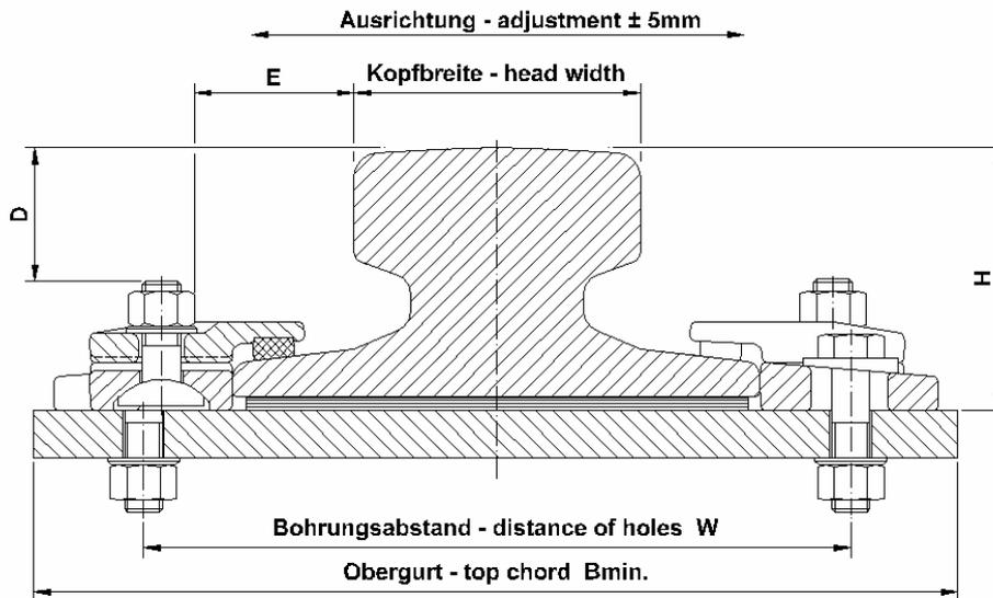
Die Klemmplatten nach dieser Norm gewähren neben dem Vorteil der engen Führung der Schiene durch die Ausrichtmöglichkeit auch den Vorteil des einfachen Zuganges von oben bei Schienenwechsel bzw. -reparatur. Die Befestigung erfolgt mit hochfesten Schrauben, die mit U-Scheiben nach DIN 6918 ausgerüstet sein müssen. Durch die keilförmige Gestaltung der Unterplatte ist eine Selbsthemmung der Befestigung gegeben.
