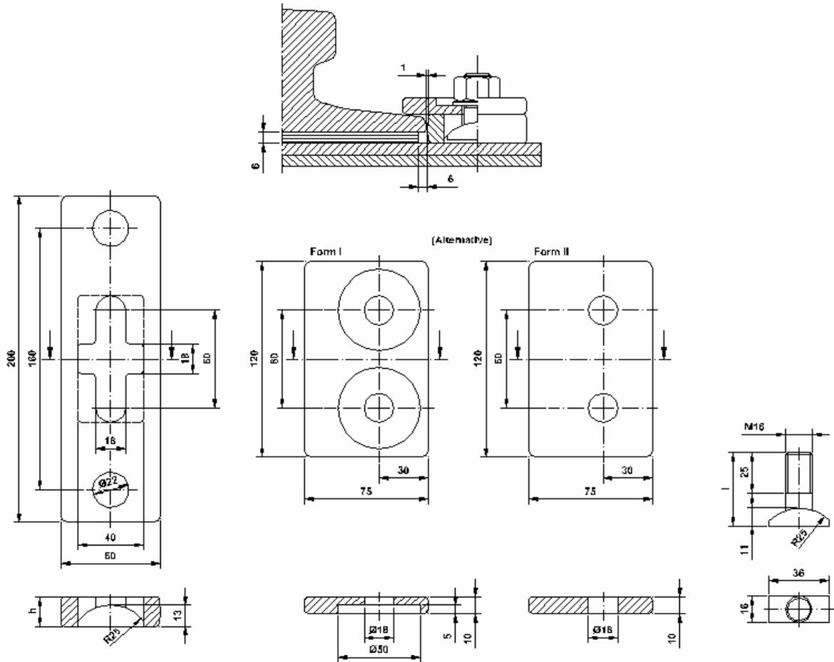
Bezeichnung einer Klemmplatte mit Deckplatte Form I für Kranschiene A 100 DIN 536 mit 6 mm Unterlage .....
