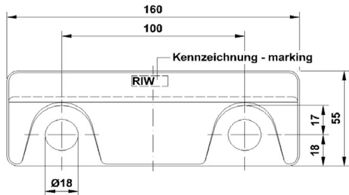
Bezeichnung einer Klemmplatte für Kranschiene A 100 mit Unterlage 6 mm .....
