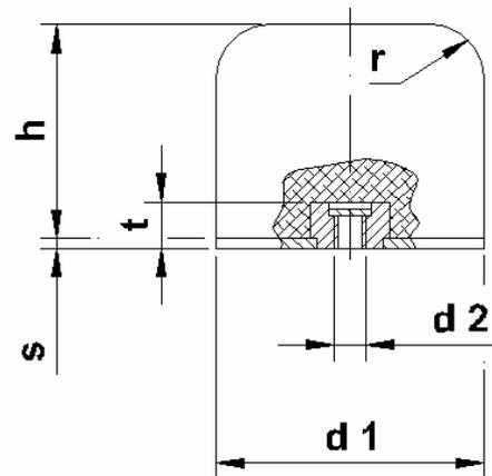
Bezeichnung eines Getriebepuffers Nenngröße 50 mit Gewindezapfen, Ausführung A ....:
