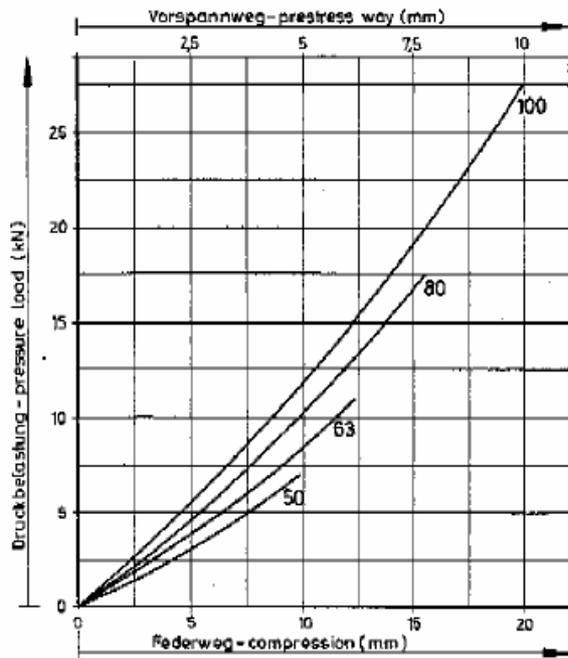
RIW - Getriebepuffer wurden für die federnde Abstützung von Drehmomenten (z.B. an Aufsteckgetrieben) entwickelt.
