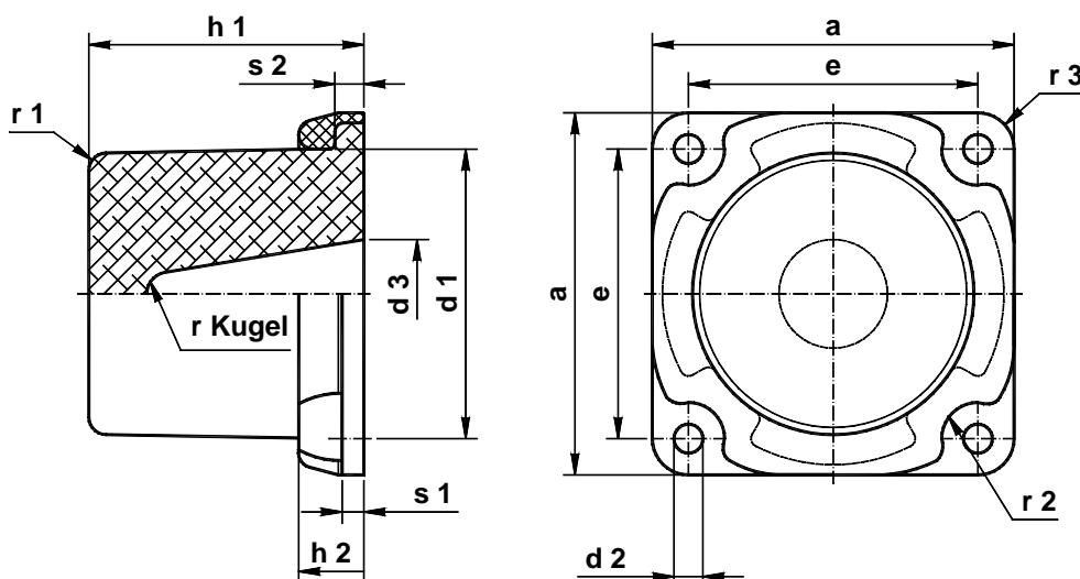
Bezeichnung eines Zellstoffpuffers mit Durchmesser d<sub>1</sub> = 125 mm, einschließlich Befestigungsplatte ....:
