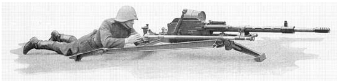
20 mm maskinkanon, opstillet til skydning på jorden. (Dansk Industri Syndikat). Fra Kilde 10.
