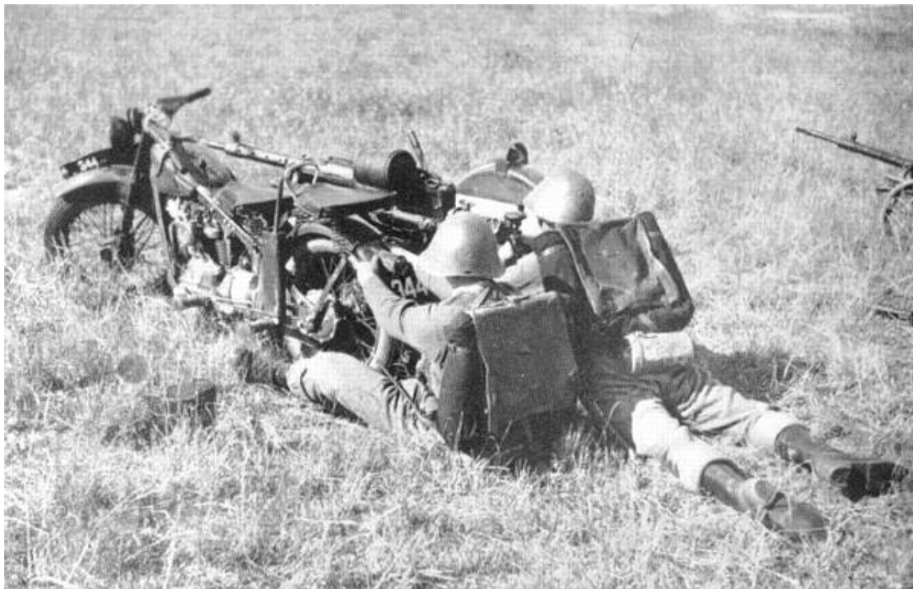
20 mm maskinkanon M.1938 - Klar til skydning, med lavetten på motorcyklen 2 ).
