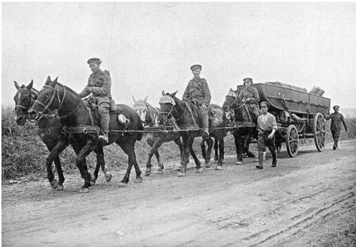
Pontonvogn med Ponton Mk II på march, cirka 1915. Midt på pontonen aner man en lodret streg, der viser, hvor de to halvpontoner er sat sammen.
