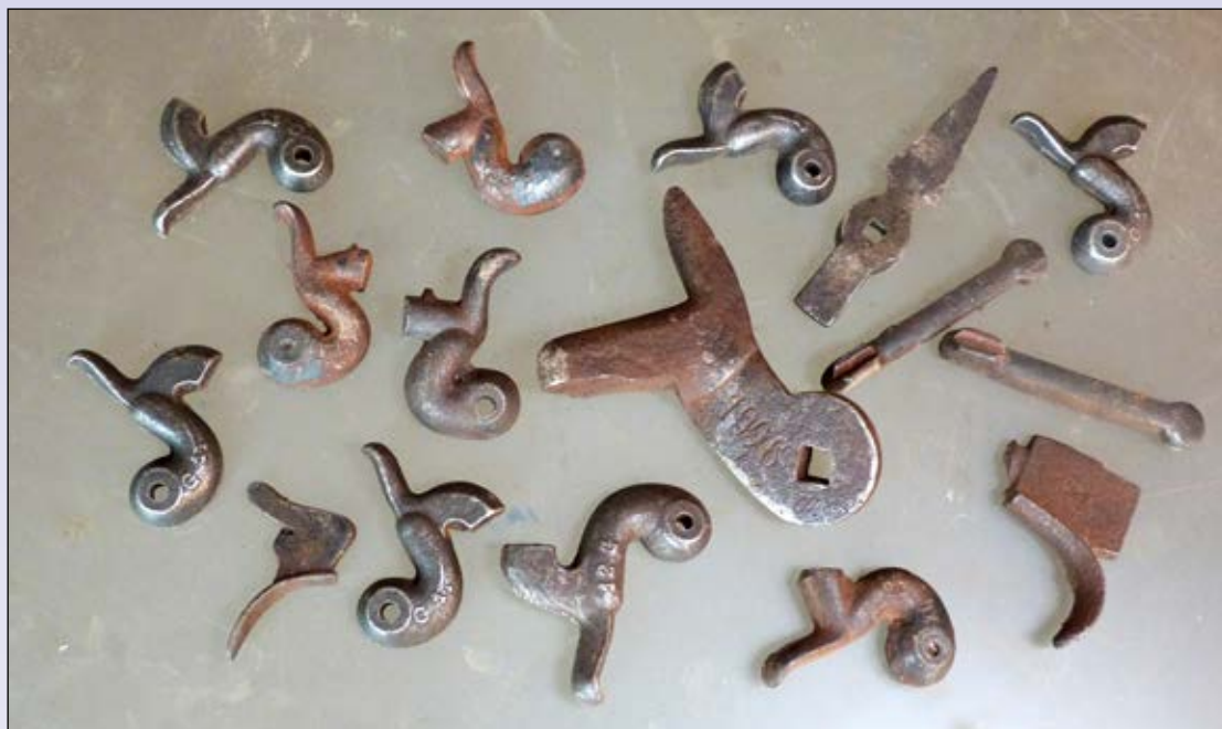
Figur 1. Sænksmedning gav ensartede, stærke og billige haner.
