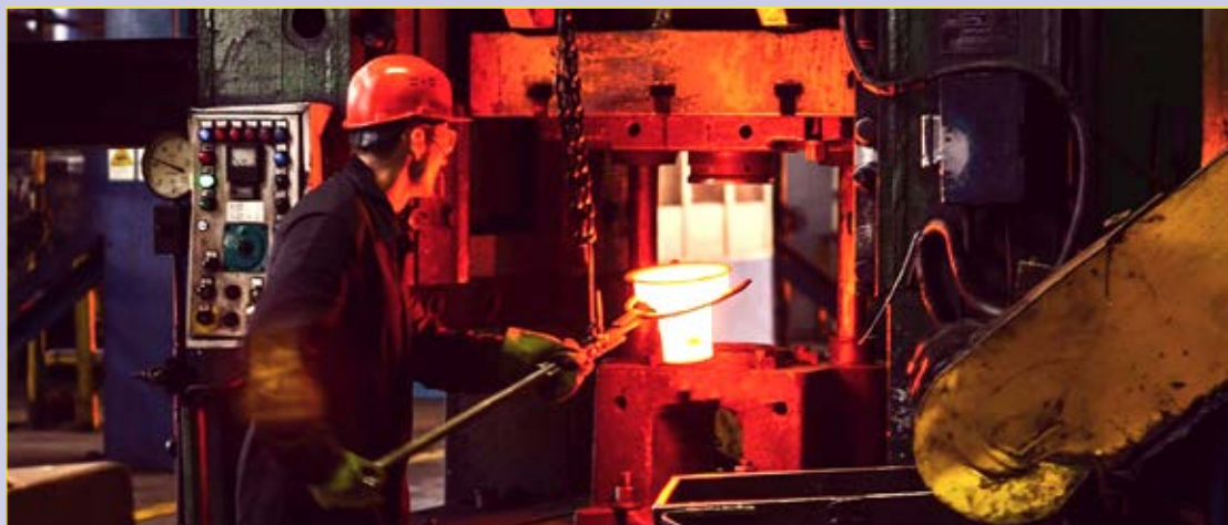
Figur 4. Presser til sænksmedning arbejder med tonsstore arbejdstryk.
