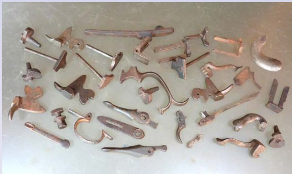
Figur 3. Våbenindustrien behøvede mange dele, egnede til sænk-smedning.
