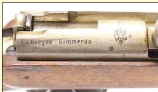
Figur 8. Højre side af låsestolen viser Dreyse som producent, samt preussisk kontrolstempel.
