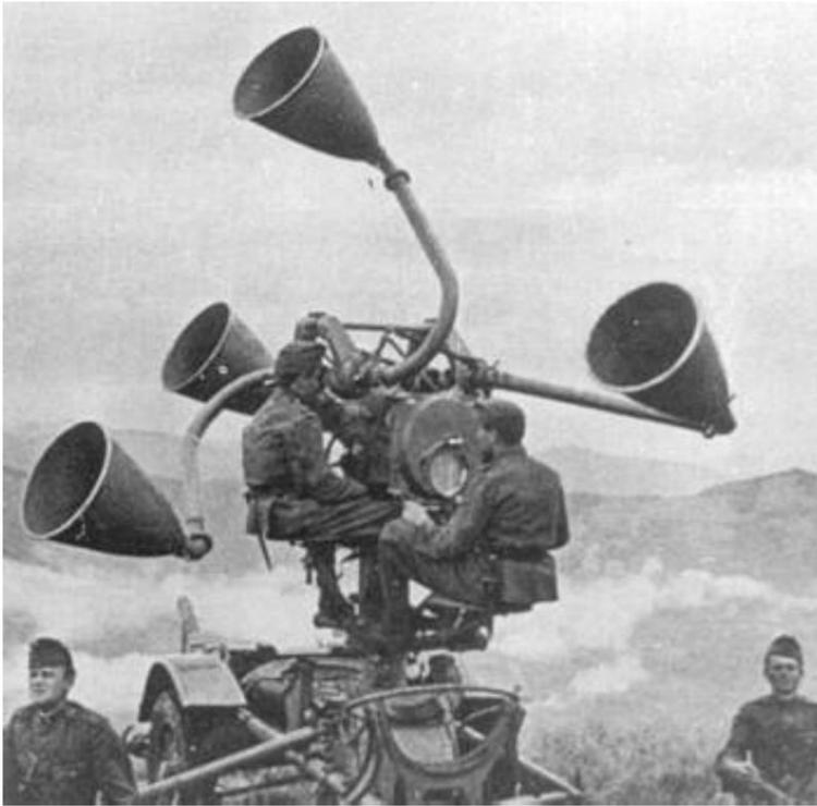
Die Ungarn gehörten zu den ersten, die radargesteuerte Flugabwehrkanonen aus ungarisch-deutscher Herstellung einzusetzen. Dadurch wurden Abhörgeräte überflüssig.
