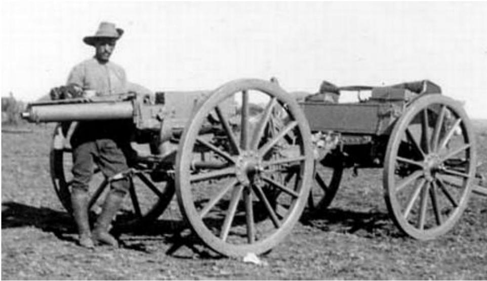
*37-mm-Maschinengewehr (Pom-Pom) aus dem Burenkrieg.*
