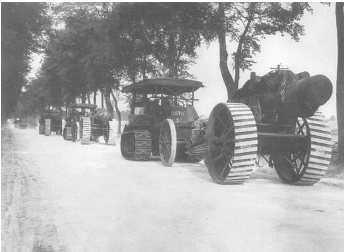
Holt 75-PS-Benzintractoren ziehen eine Batterie von 8-Zoll-Haubitzen Mk 1-5 in Amiens, September 1916. Von Quelle 3.
