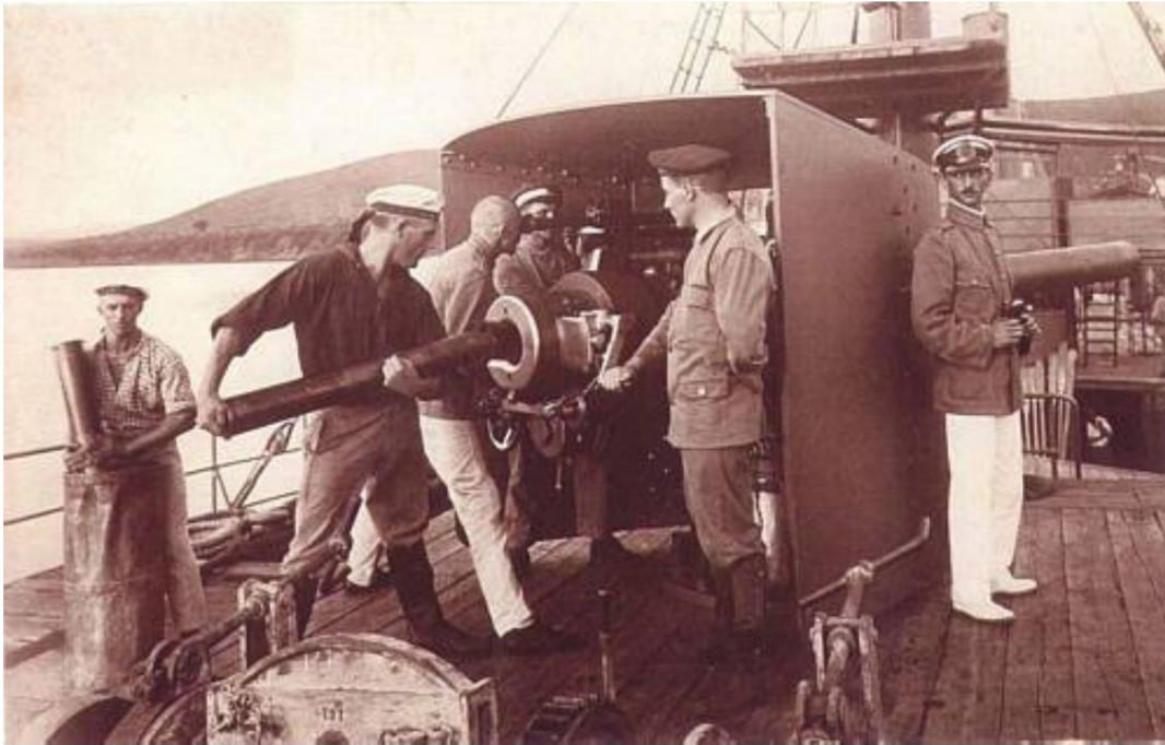
10,5-cm-Kanone 1 ) vom Kreuzer SMS Königsberg, hier montiert auf dem Kanonenboot Graf von Götzen; das Foto wurde Mitte Oktober 1915 in Uvira am Tanganjikasee aufgenommen. Von Quelle 1
