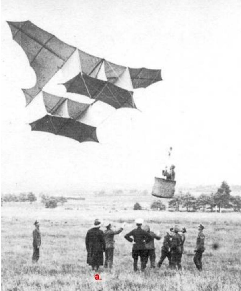
Cody cerf-volant, avec un observateur suspendu dans un panier. De la source 6, qui date la photo de 1907.
