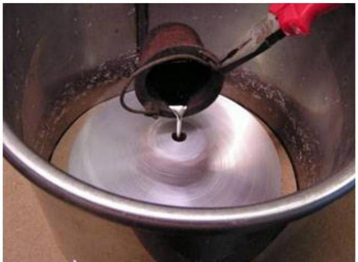
2. & 3. Le moule est mis en rotation dans la "machine" et l'étain liquide est versé dans le trou central.
