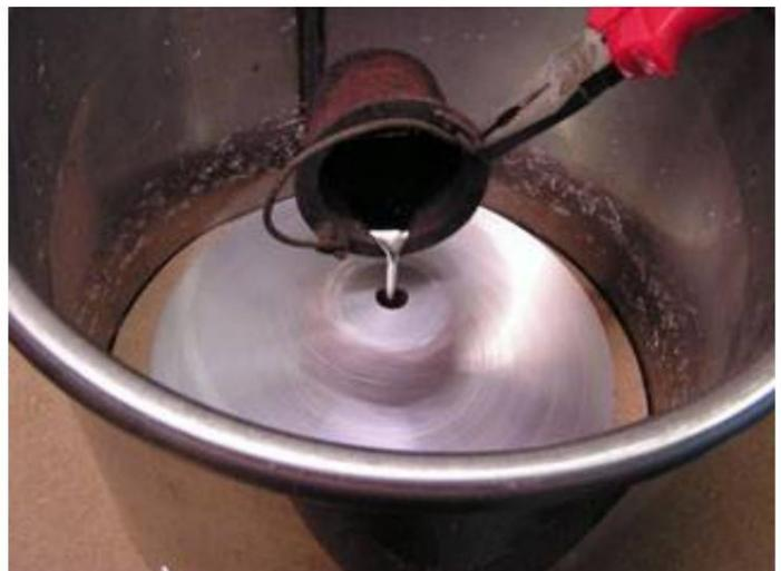
2. & 3. Die Form wird in der "Maschine" in Rotation versetzt und das flüssige Zinn in das Mittelloch gegossen.
