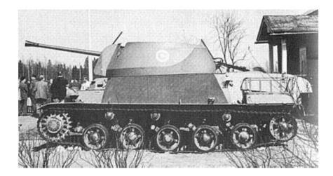
Le Landsverk L62, comme le type était désigné par l'usine, consistait essentiellement en un châssis Landsverk L60, sur lequel était montée une tourelle avec un canon anti-aérien de 40 mm L/60.
