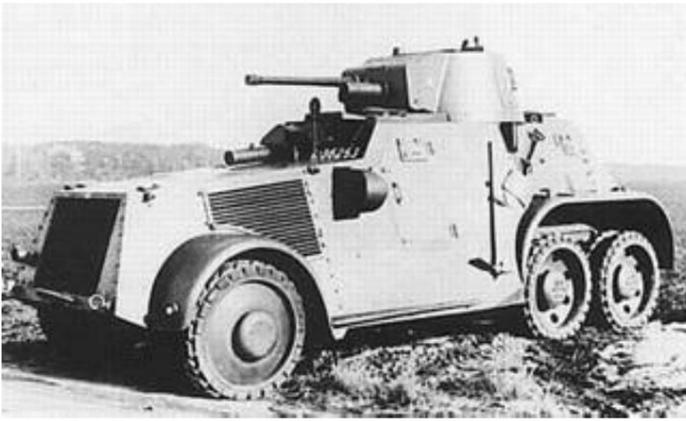
*Gepanzertes Fahrzeug Landsverk 180.
