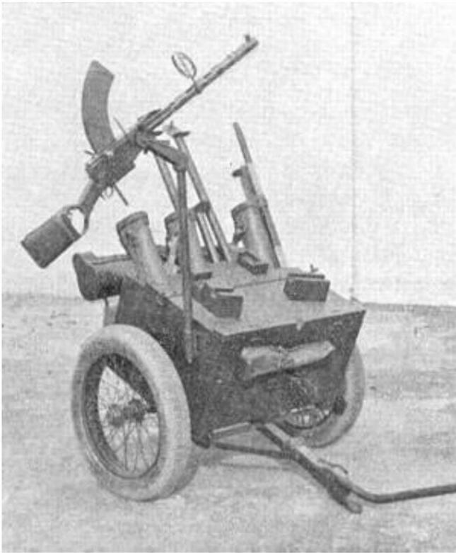
Maschinengewehrwagen M. 1932, mit Maschinengewehr im Luftzieldrehpunkt.
