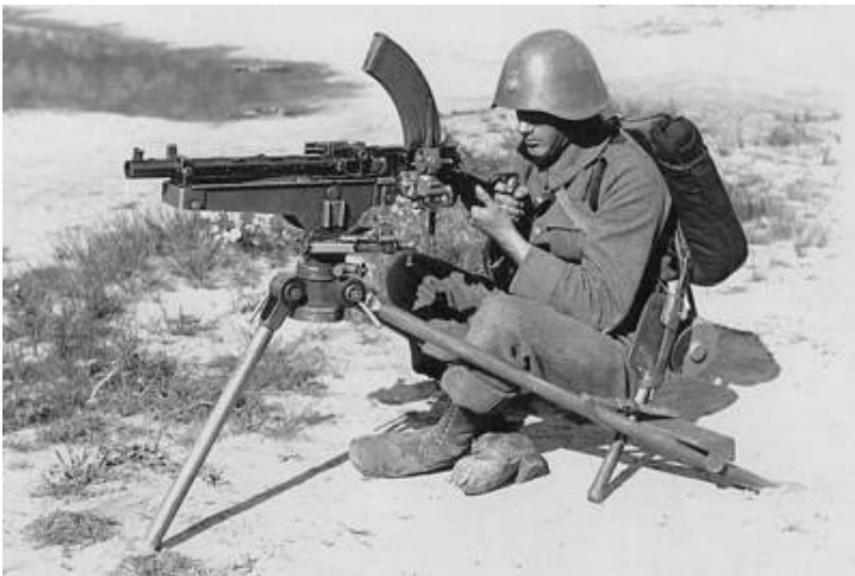
8-mm-Maschinengewehr M.1929 im Maschinengewehrstativ M.1929. Von Quelle 9.
