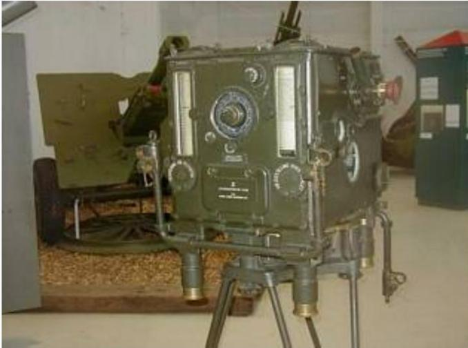
Das Okular an der langen Seite des Korrektors (obere zwei Bilder) wird verwendet, um die Höhenrichtung des Ziels zu beobachten, während das entsprechende Okular an der anderen langen Seite (die mittleren zwei Bilder) verwendet wird, um die seitliche Richtung des Ziels zu beobachten.
