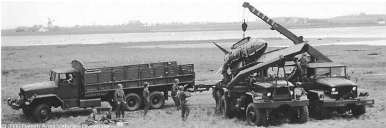
Einige der Komponenten des Honest John-Raketensystems: M55-Raketenwagen, M289-Raketenführung und M62-Kranwagen.
