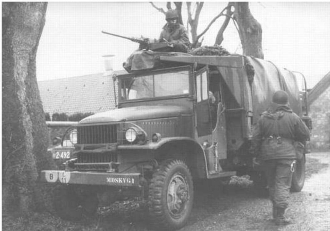
2 1/2 t GMC, 6x6, CCKW-353, LKW, mit 12,7-mm-Maschinengewehr M/50 in Flugabwehrwagenhalterung M/50.
