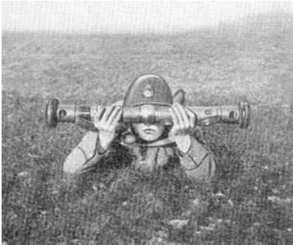
Distancemètre M.1915. De Source 5.
