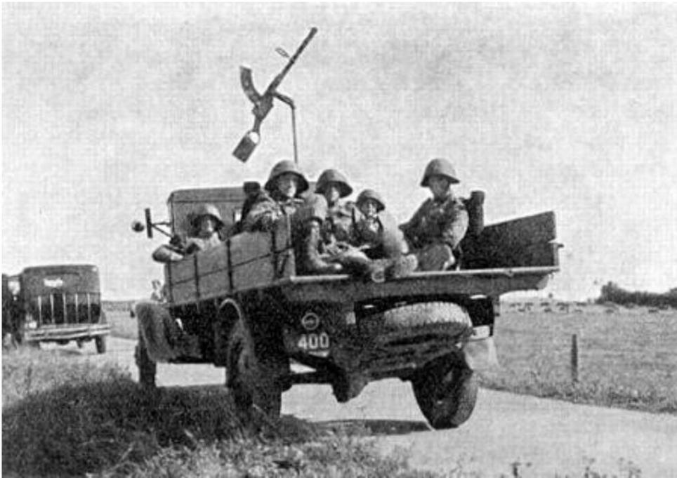
Camion, avec mitrailleuse montée en pivot anti-aérien.
