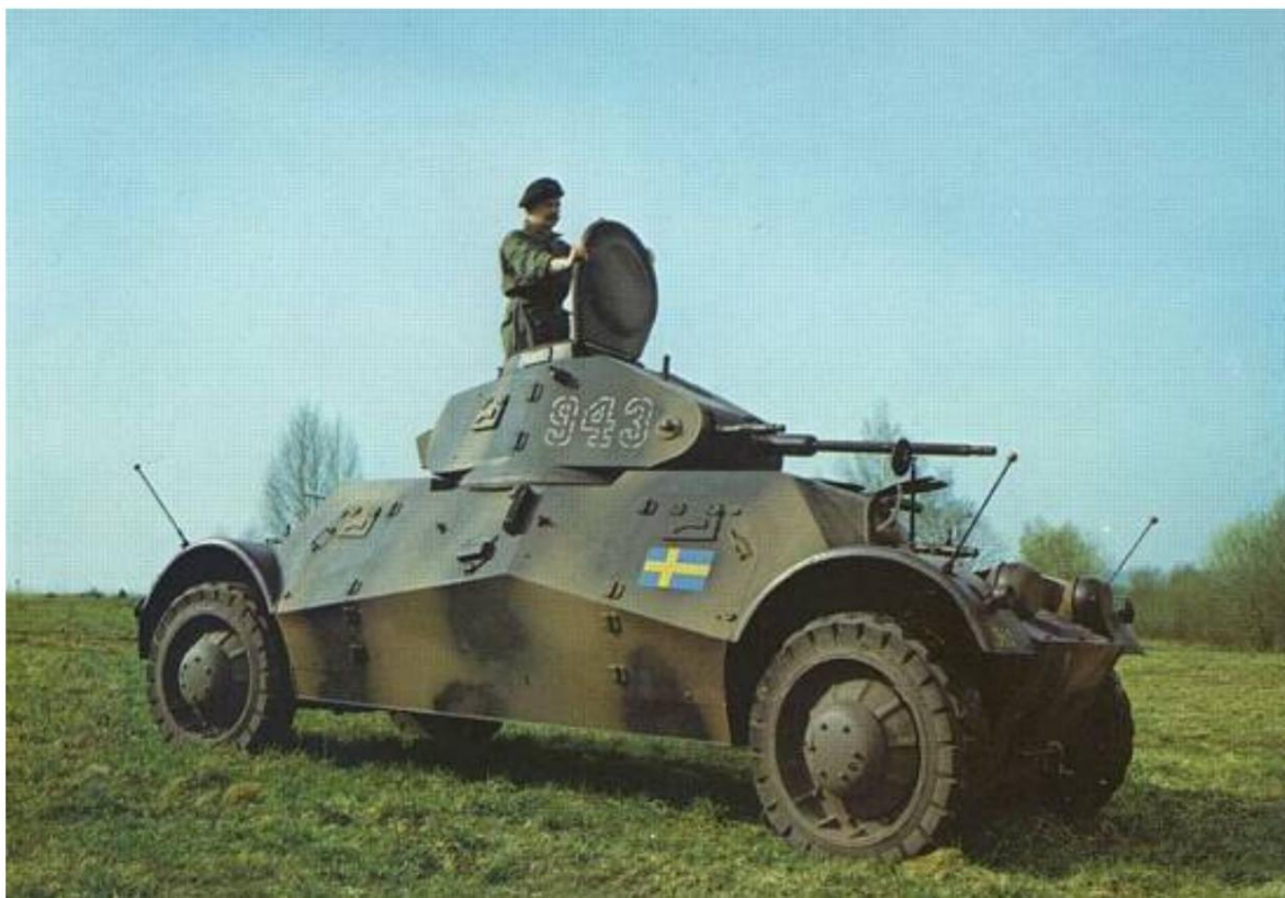
Une voiture blindée Landsverk Lynx, qui en service suédois a été désignée comme Pansarbil m/40. Reproduit à partir d'une carte postale du Pansar Museet Axvall.
