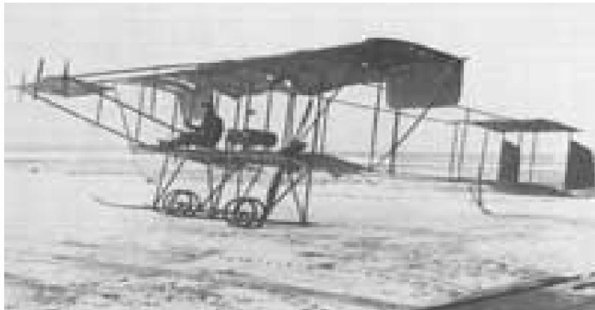
L'avion Glenten, le premier avion de la marine, avait un moteur de 50 ch et une vitesse de pointe de 80 km/h. (Photo des archives Orlogsmuseet )
