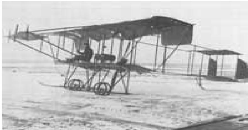
Das Flugzeug Glenten, das erste Flugzeug der Marine, hatte einen 50-PS-Motor und eine Höchstgeschwindigkeit von 80 km/h. (Foto aus dem Archiv des Orlogsmuseet)
