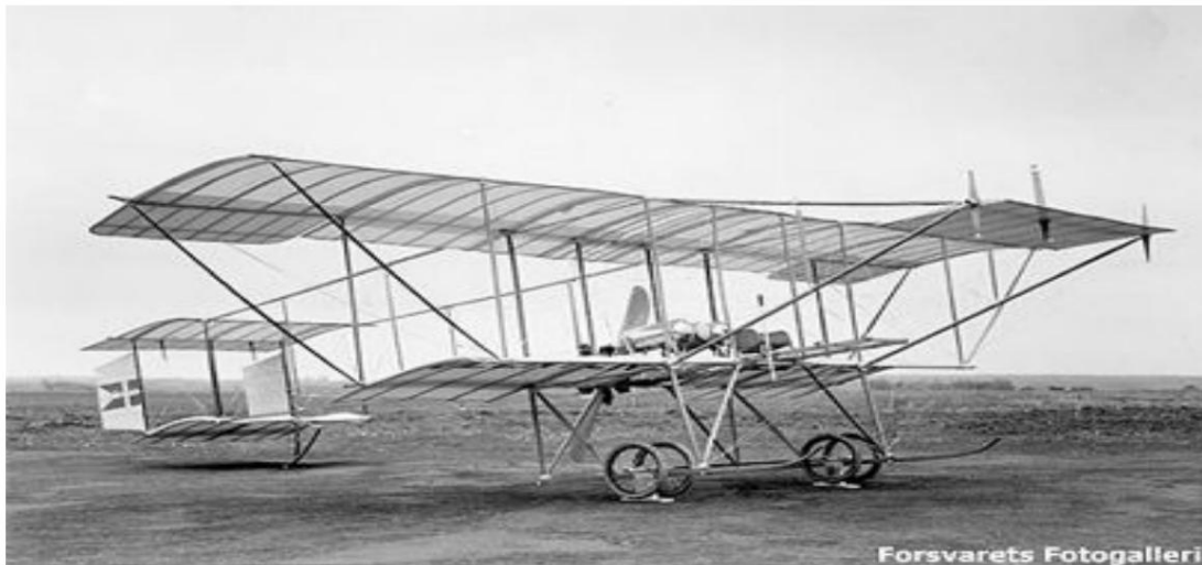
L'avion Glenten, le premier avion de la marine, avait un moteur de 50 ch et une vitesse de pointe de 80 km/h. (Photo de la Galerie de photos de la Défense)
