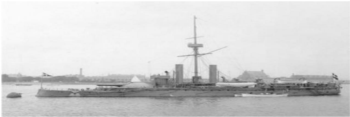
Le navire blindé Tordenskjold, lancé en 1880, n'était pas seulement le premier navire de la flotte construit principalement en acier, mais fut pendant de nombreuses années le navire blindé le plus lourdement armé des Nordiques avec son canon de 35 cm. (Photo des archives Orlogsmuseet)
