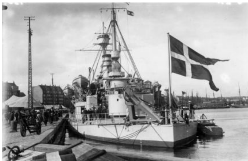
Flere af flådens større skibe blev efter ulykken udstyret med en kran agter til løftning af ubåde.
