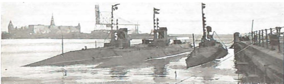
Undervandsbådsstationen i Helsingør under Sikringsstyrken. Fra venstre: 2den April , Nymfen og Thetis . Man bemærker periskopovertrækkene, flagspillene mellem periskoperne og haleflagene, der angav bådernes agterende
