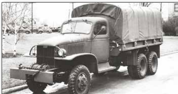
GMC CCKW 353 B1 (lang model) med frontspil. Foto: General Motors.
