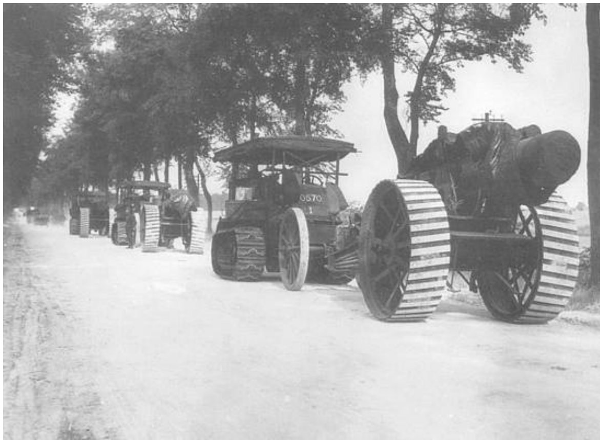
Holt 75-h.p. Petrol Tractors trækker et batteri 8" haubitser Mk 1-5 ved Amiens, september 1916. Fra Kilde 3.
