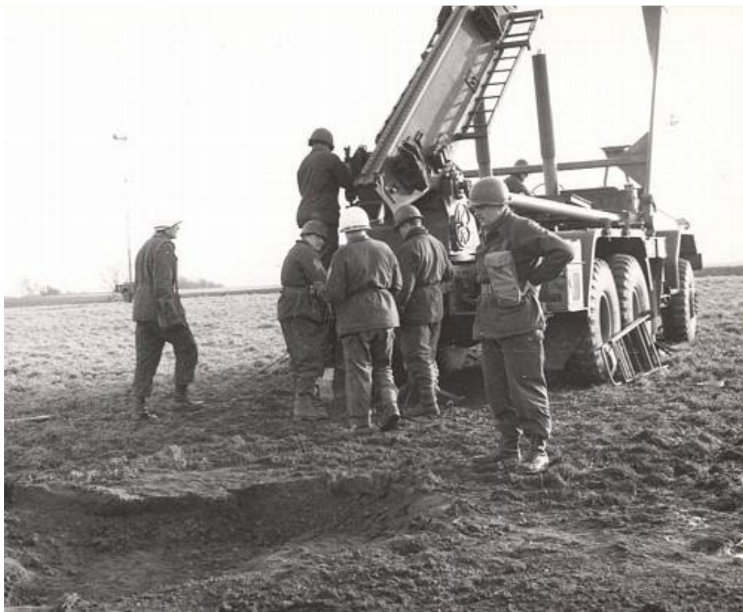
Klargøring af 762 mm raketstyr Va M289 Honest John. Fra Jesper Vilhelmsen via Ole Willumsen.
