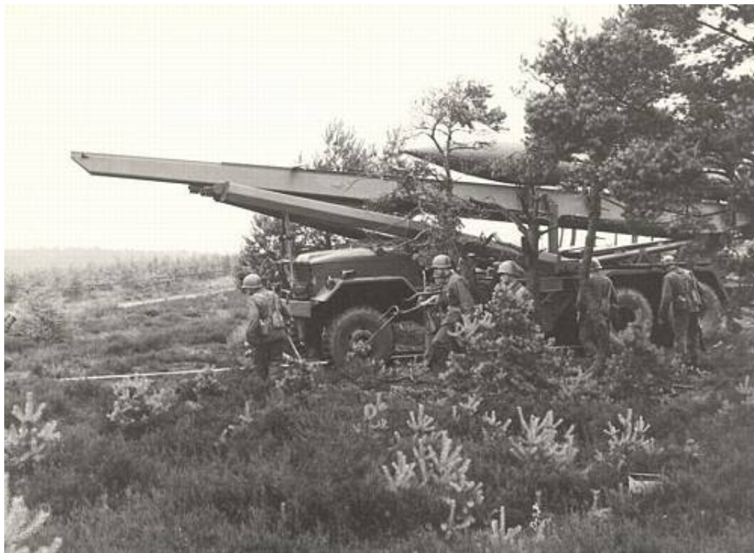
762 mm raketstyr M289 Va Honest John, i lurestilling. Fra Jesper Vilhelmsen via Ole Willumsen.
